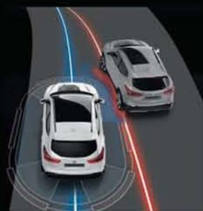
**INTELLIGENT TRACE CONTROL.** Ce système actionne et ajuste automatiquement les freins dans les virages pour optimiser les courbes et empêcher le sous-virage.
