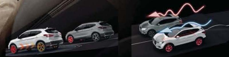
**INTELLIGENT 4x4\*.** Cette transmission utilise des capteurs électroniques qui contrôlent le patinage des roues pour répartir automatiquement le couple jusqu'à 50% sur les roues arrière.
